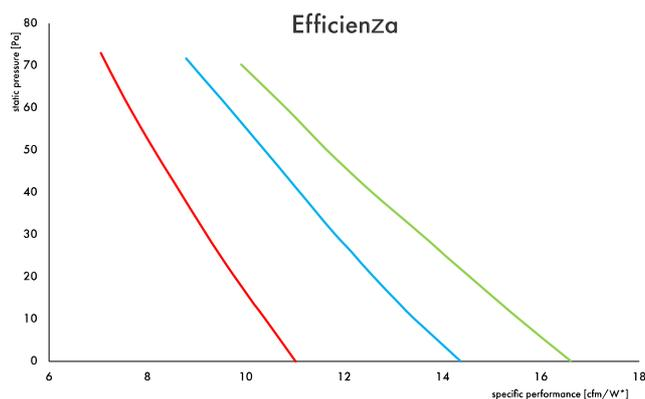
— ED36HE, — ED30HE, — ED24HE. Dati sul flusso d'aria e sull'efficienza misurati in condizioni standard (20°; 1013 hPa). \*1 cfm/W = 1.7 m³/hW
